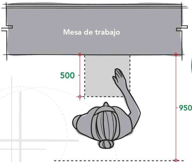
La distancia sugerida de apertura de un cajón en la mesa de trabajo es de 500mm hacia afuera.
